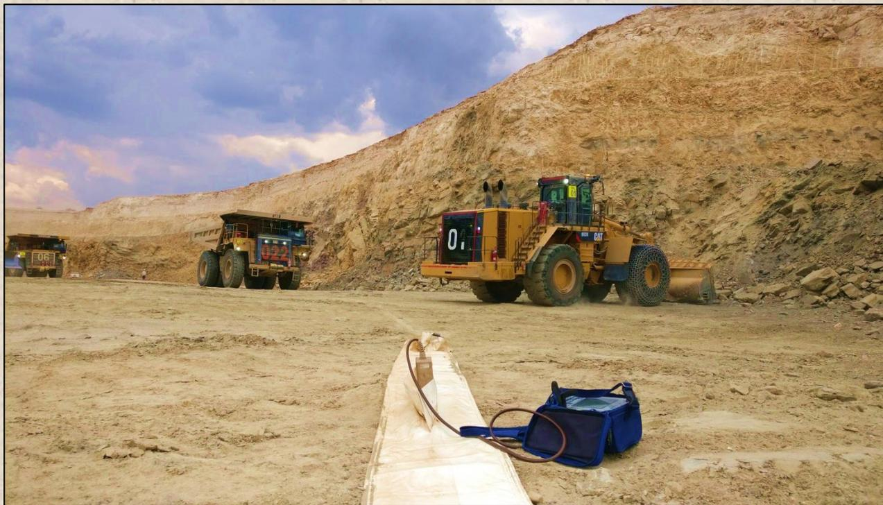
Георадар «Лоза» – это импульсный электромагнитный радиолокатор подповерхностного зондирования. С помощью георадара можно не нарушающим способом исследовать геологическую структуру земной поверхности на глубины десятков и сотен метров. Применение георадаров особенно эффективно в геологоразведке, инженерной геологии.
